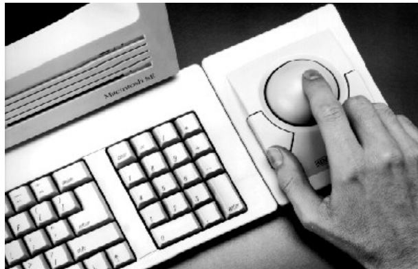
(شکل 1-3) این شکل نشان دهنده توپ مکان نما کامپیوتر می باشد.
