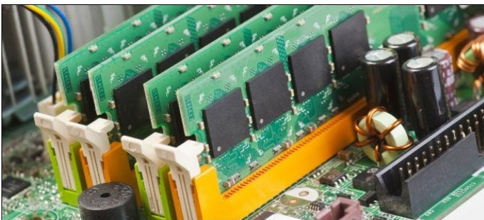
(شکل 1-13) حافظه RAM کامپیوتر می باشد.
