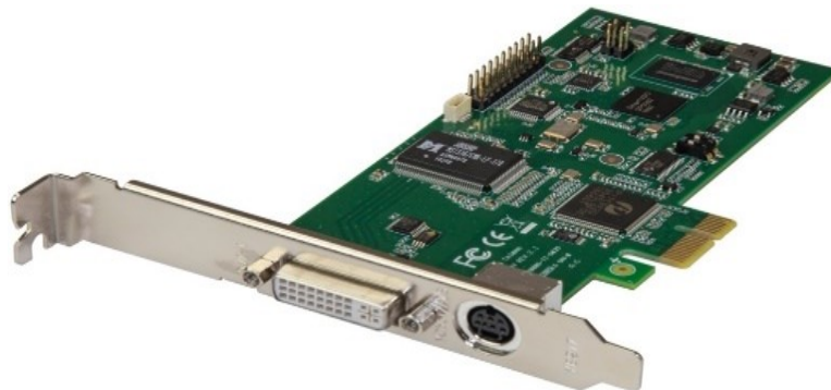
(شکل 1-20) این شکل نشان دهنده ء کارت اخذ تصویر می باشد.
