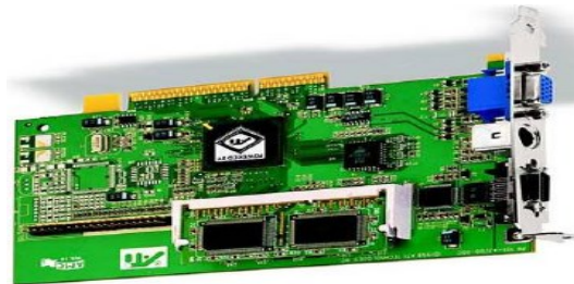
(شکل 1-19) این شکار نشان دهنده ء کارت گرافیک کامپیوتر می باشد.
